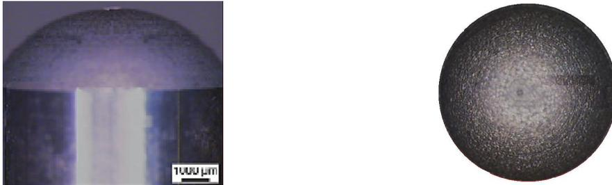
Figure 2-6 Profil cylindrique et surface d'un pion neuf en carbure WC/Co
