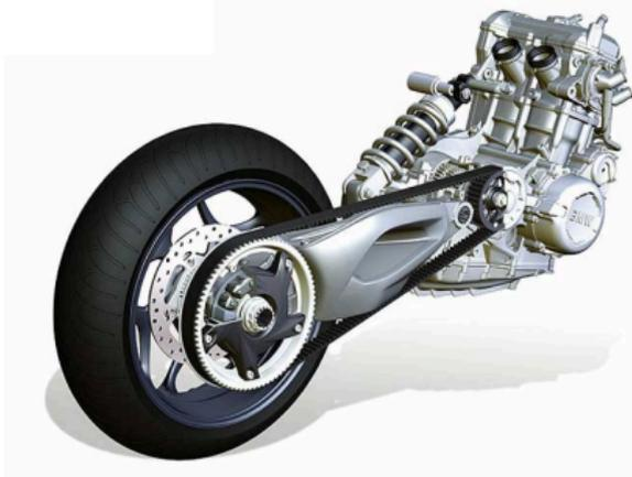
*Transmission par courroie crantée*
