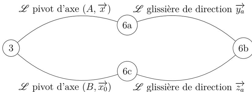
Les pièces **6a**, **6b** et **6c** étant en liaisons glissières, il est clair que les bases associées  $\mathcal{B}_a$ ,  $\mathcal{B}_b$  et  $\mathcal{B}_c$  sont confondues et que l'on a  $\theta = \alpha$  tel que :
