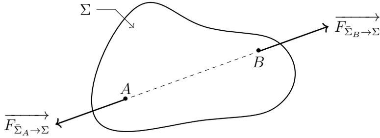
FIGURE 2 – Système matériel soumis à deux glisseurs.
