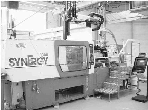
FIGURE 4.1 – Cellule d'injection.
