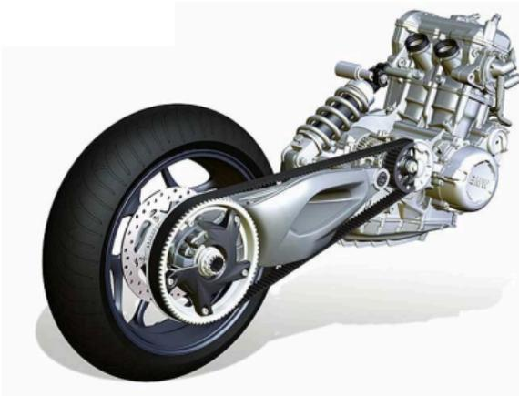
*Transmission par courroie crantée*
