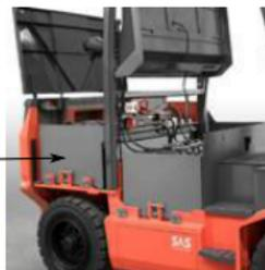
Les batteries d'accumulateur
