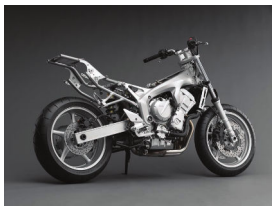
Bloc-moteur de Yamaha FZ6 Fazer en alliage d'aluminium
